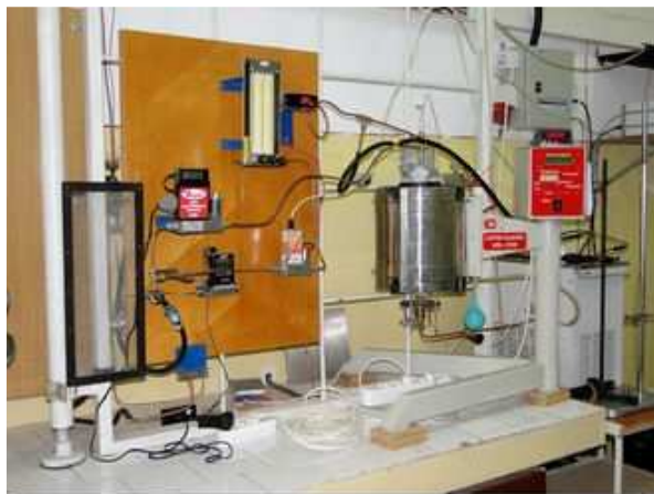
Instalatie experimentală destinată studiilor cinetice în procesele de combustie catalitică a compusilor organici volatili (COV)
