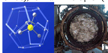
Fig.1a,b. Formarea de hidrați între moleculele de metan și apă (46.H 2 O + 8.CH 4 ), ce pot obtura conductele, este favorizată de presiunea ridicată și temperatura scăzută.[2]
