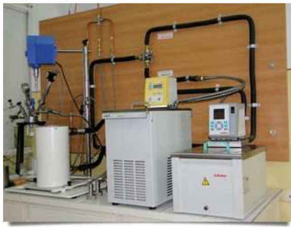
Instalatie experimentală destinată studiilor cinetice ale unor procese catalitice eterogene lichid –solid
